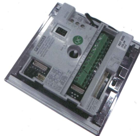
Figura 9.5. Amplificador de la placa de calle.
